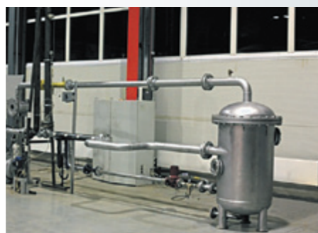
Рис. 13. Стенд для калибровки трехфазных расходомеров и датчиков-регистраторов
